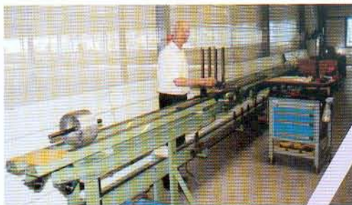
Machine à souder les agrafes sur les poteaux (en cours de fabrication) André Verpillat
